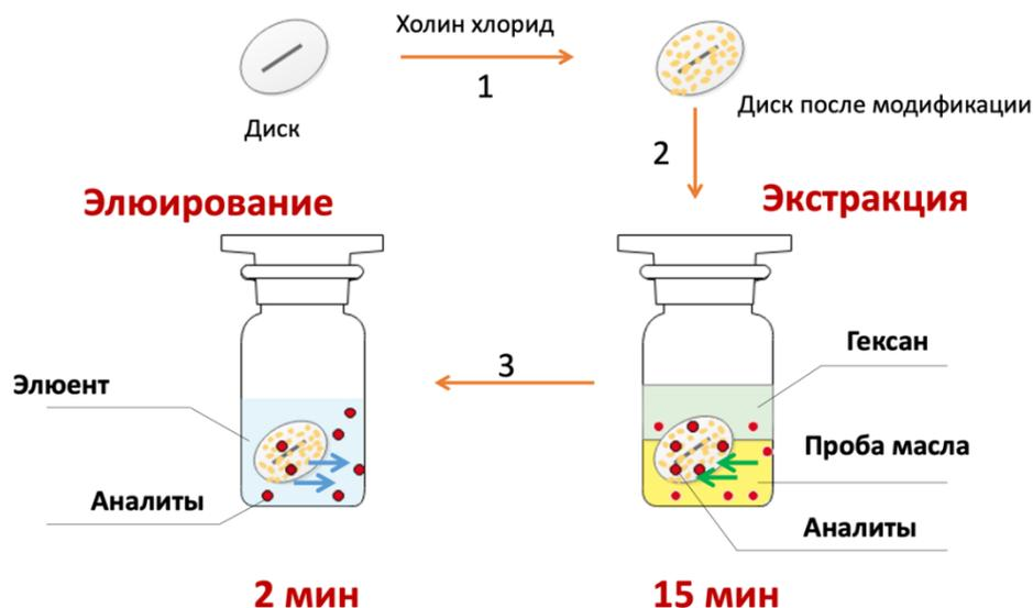
Рисунок 66 – Схема микроэкстракции полифенольных соединений из пищевых масел с *in situ* образованием ЭР с хлоридом холина
