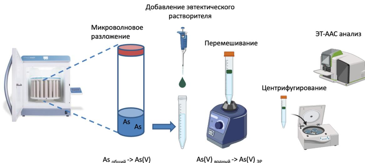
Рисунок 79 – Схема микроэкстракции мышьяка из раствора минерализата пищевого продукта в гидрофобный ЭР
