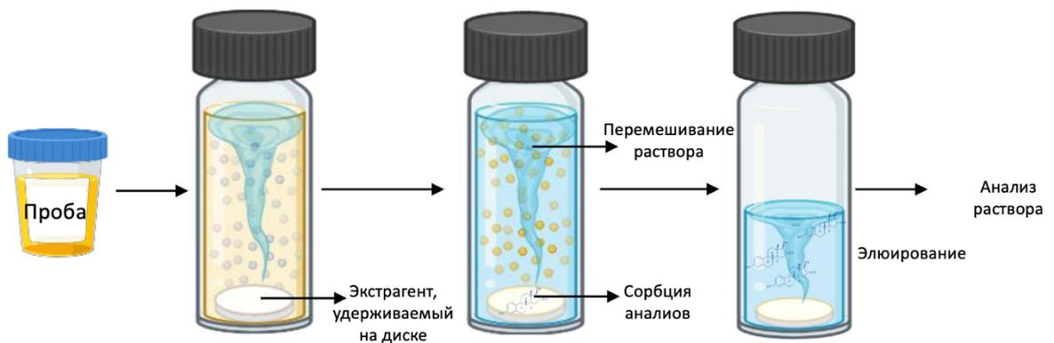
Рисунок 13 – Схематическое изображение жидкостной микроэкстракции с использованием вращающегося диска [212]
