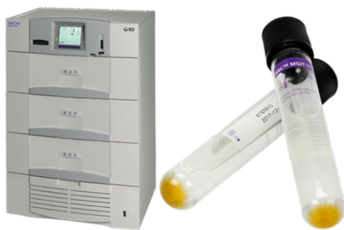
Рис. 1.1. Система регистрации микобактериального роста ВАСТЕС MGIT 960 и используемые в ее работе флаконы с жидкой средой (в нижней части виден индикаторный элемент). Источник – фото с сайта производителя (Becton Dickinson, США): www.bd.com .
