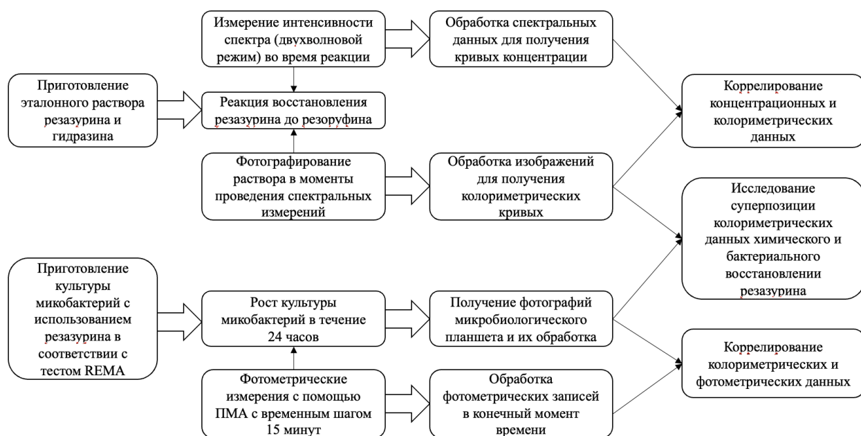
Рис. 2.10. Схема калибровки данных, направленная на выявление корреляции между данными UV-Vis, колориметрии и фотометрии, и соответствующих микробиологических измерений на ее основе.
