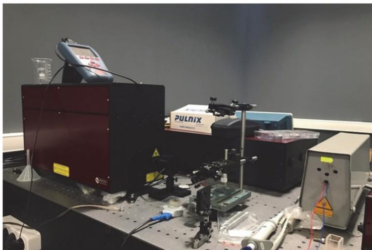
Рис. 18. Установка фемтосекундной лазерной абляции с системой фокусировки луча на поверхности металлической пластины.
