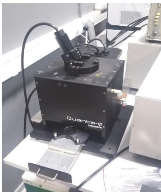
Рис. 35. Интегрирующая сфера Quanta-φ
