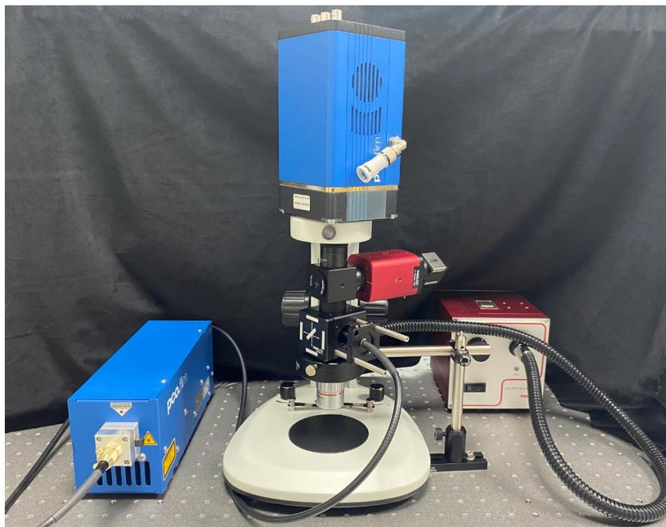
Рисунок 4.15 – Внешний вид разработанной макроскопической системы для визуализации времени жизни флуоресценции в частотной области
