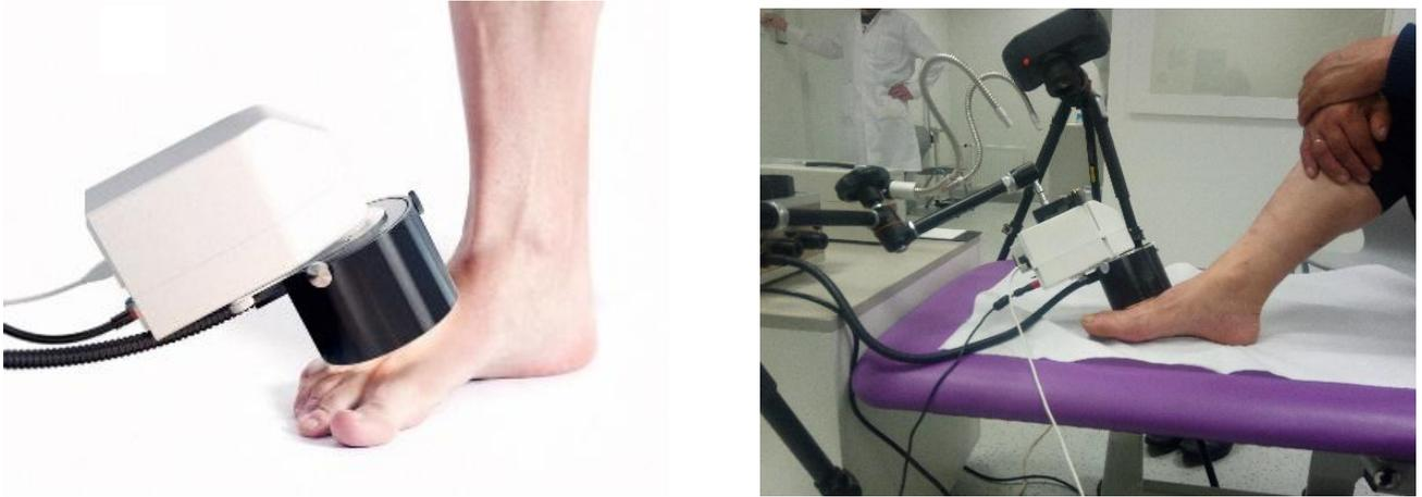
Рисунок 2.20 – Внешний вид портативной поляризационно-чувствительной системы ГСВ и ее расположение на специализированном штативе во время измерений в клинических условиях
