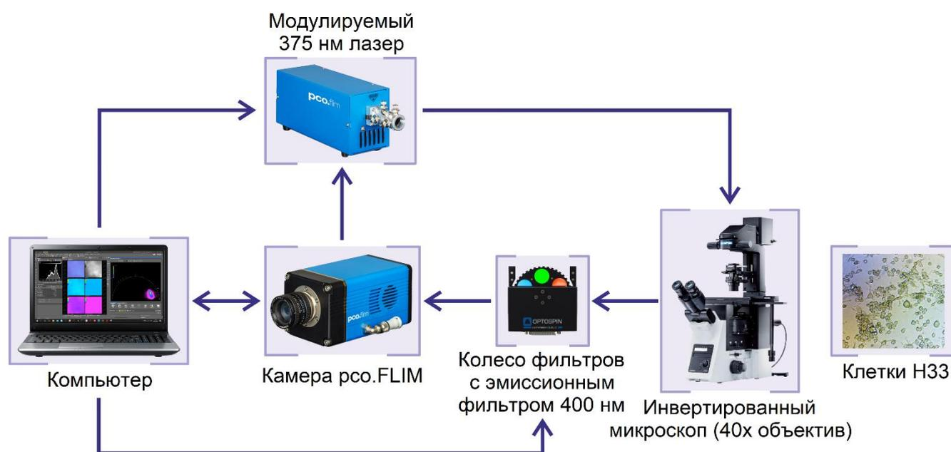
Рисунок 4.12 – Микроскопическая система визуализации времени жизни флуоресценции
