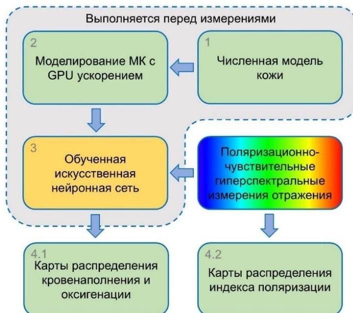
Рисунок 2.6 – Блок-схема обработки гиперспектральных данных. Шаги 1-3 выполняются до измерений. Шаг 4 – в соответствии со сбором данных
