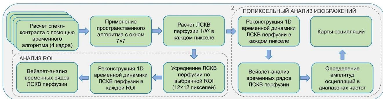
Рисунок 5.14 – Блок-схема обработки данных ЛСКВ, объясняющая шаги алгоритма анализа выбранных ROI (1), а также анализа полного изображения (2)
