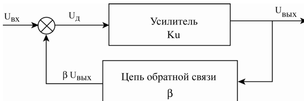
Рис. 7. Принцип действия отрицательной обратной связи
