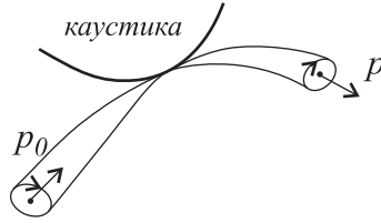
Рис. 17.3. Изменение ориентации сечения лучевой трубки при касании каустики
