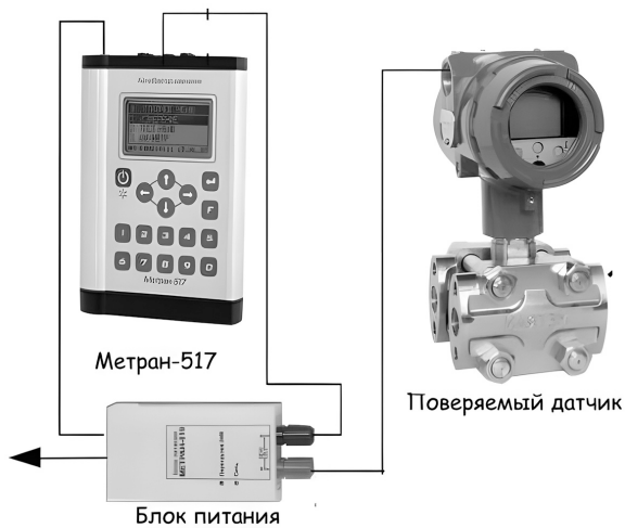
Рис. 4. Схема подключения «Метрана-517»
