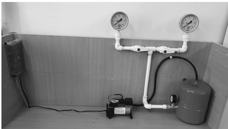
Рис. 1. Внешний вид учебно-лабораторного стенда по поверке измерительных преобразователей давления
