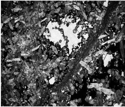
Рис. 1. Турмалин, флюорит, касситерит в грейзене. Дорудная трещинка милонитизации
