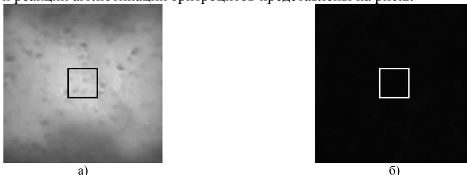
Рис.2. Типичные фотографии засветки кюветы в зеленом канале RGB с исследуемым раствором для: а) положительной и б) для отрицательной реакций агглютинации эритроцитов. Прямоугольником выделены зоны статистической обработки экспериментальных результатов
