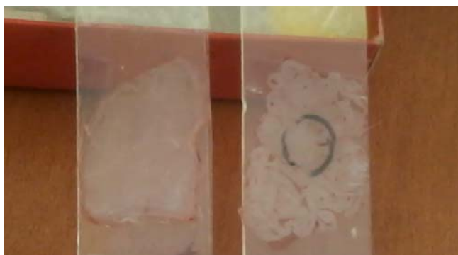
Рис. 2. Мышечный слой и слизистая/подслизистая оболочка брюшины, закрепленные между двумя предметными стеклами для проведения спектральных измерений
