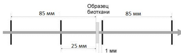
Рис. 3. Схема приставки для измерения коллимированного пропускания образцов биоткани
