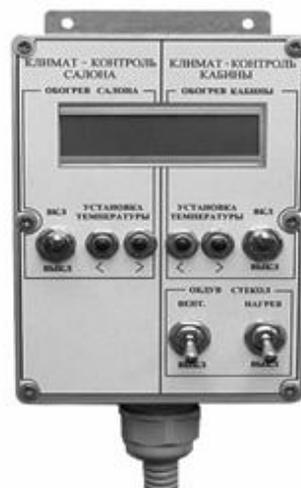
Рис. 7. Внешний вид блока управления и индикации БУИ-1 системы климат - контроля троллейбуса
