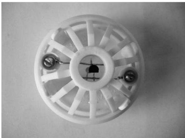
**Рис. 3. Фотография цифрового датчика DS1820 в корпусе**
