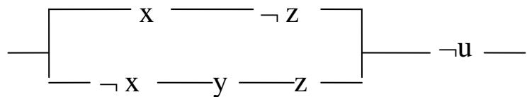
3. Найти отсутствующий элемент в схеме, заданной функцией проводимости  $f(x, y) = x \vee \neg y$ :
